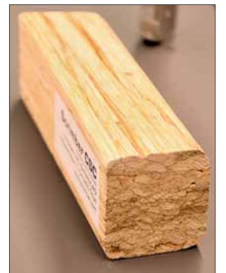
Bislang noch nicht auf dem Markt: Konstruktives Bauprodukt „Scrimber“
