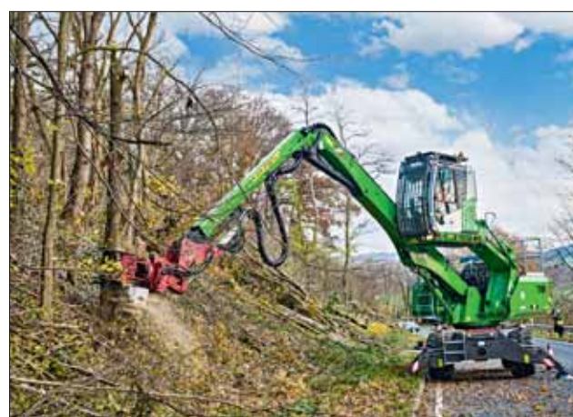
Mit dem Fällbagger können ganze Bäume schnell gefällt und sicher abgelegt, oder segmentweise abgeschnitten werden. Die höhenverstellbare Kabine bietet dabei ideale und sichere Arbeitsbedingungen. Fotos: Sennebogen
