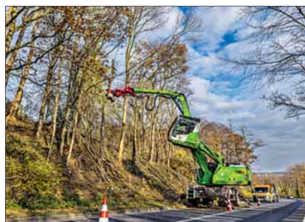
Mit dem Fällbagger können ganze Bäume schnell gefällt und sicher abgelegt, oder segmentweise abgeschnitten werden. Die höhenverstellbare Kabine bietet dabei ideale und sichere Arbeitsbedingungen. Fotos: Sennebogen
